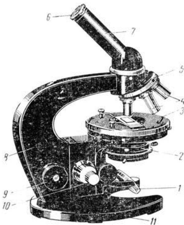
Рис. 8. Микроскоп МБИ-1: 1 - зеркало, 2 - конденсор, 3 - предметный столик, 4 - объективы, 5 - револьвер, 6 - окуляр, 7 - тубус, 8 - тубусодержатель, 9 - макрометрический винт, 10 - микрометрический винт, 11 - ножка
